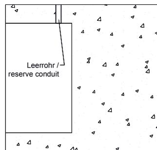
3. Einbaudose einsetzen und mit Leerrohren verbinden.
