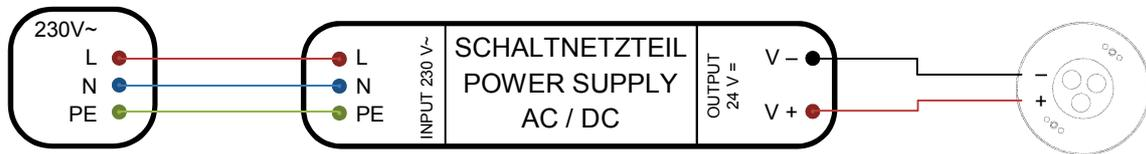
**Bitte nur Netzteile mit 24 V= Ausgangsspannung verwenden**
