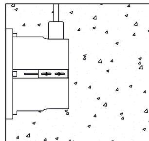
4. Leitungen mit der Leuchte verbinden und Leuchte in die Dose einbauen
